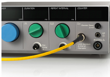
Collegamento del cavo in fibra ottica alla famiglia di console laser OcuLight
